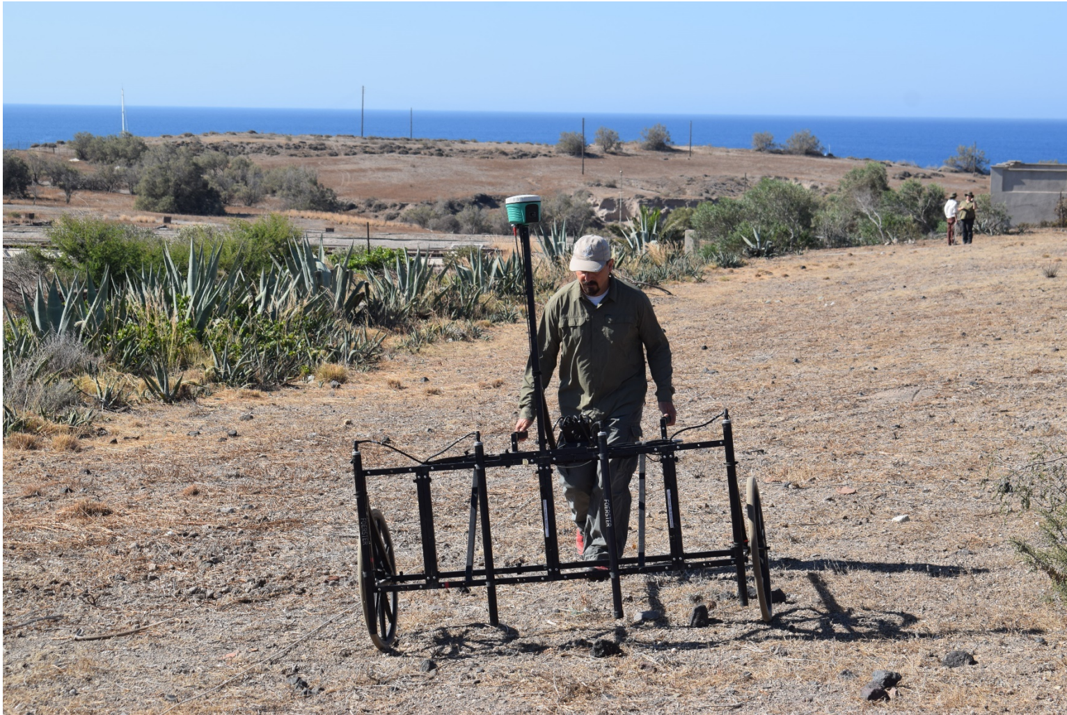
Φωτ. 3.1.1. Αρχαιολογικός χώρος Ακρωτηρίου. Μετρήσεις της βαθμίδας του ολικού μαγνητικού πεδίου με συστοιχία εποχούμενη και αποτελούμενη από 4 διαφορεικά μαγνητόμετρα.
