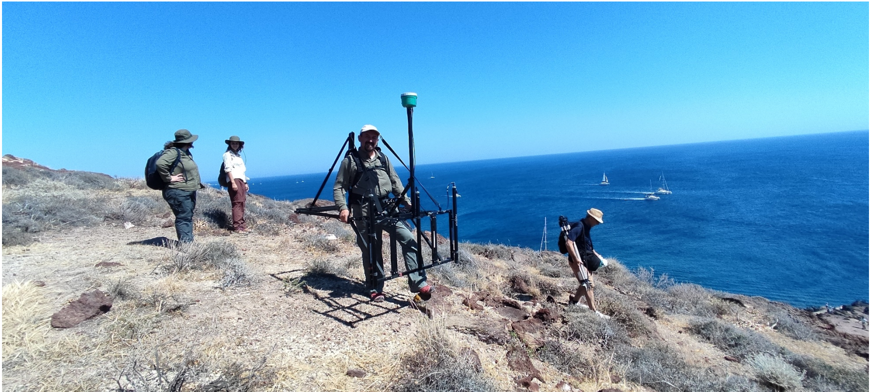
Φωτ. 3.1.II. Κόκκινο Βουνό. Μετρήσεις της βαθμίδας του ολικού μαγνητικού πεδίου με συστοιχία μαγνητομέτρων αναρτημένη στον χειριστή. Στη συγκεκριμένη εφαρμογή χρησιμοποιήθηκαν 3 διαφορεικά μαγνητόμετρα..
