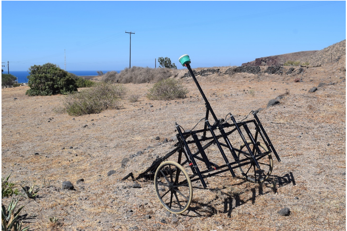
Φωτογραφία 2.3.Ι. Συστοιχία διαφορικών μαγνητομέτρων ρυθμιζόμενης μαγνητικής ροής κατά τη διάρκεια των μετρήσεων πεδίου.
